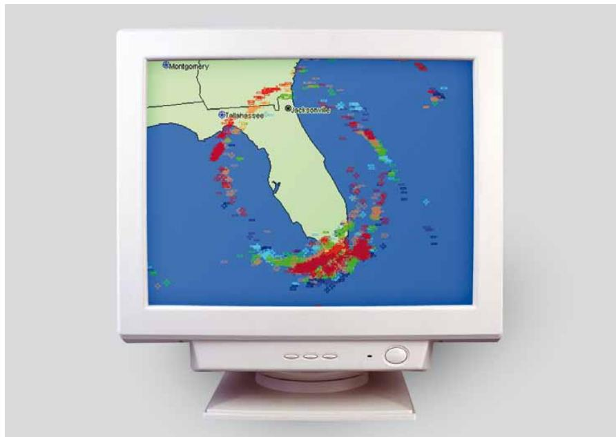
En el modo de visualización "descargas", la localización individual de los rayos se muestra como + ó - para identificar polaridad positiva o negativa, con códigos de colores según intervalos de tiempo. El tamaño del marcador puede ajustarse para representar la amplitud del evento en kiloamperios (kA).
